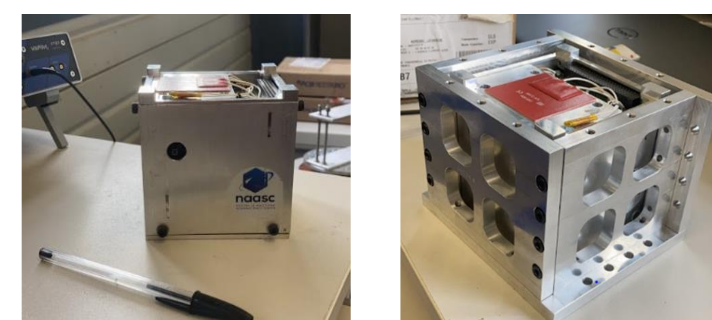
Cubesat STM inséré dans un éjecteur de test vibratoire
