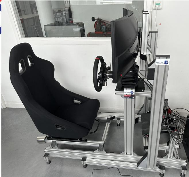
Ce simulateur a été conçu par des étudiants, supervisés par des professeurs. Son objectif principal est de permettre aux étudiants d'analyser l'impact de divers paramètres de la voiture sur les données des capteurs et sur l'expérience de conduite.
