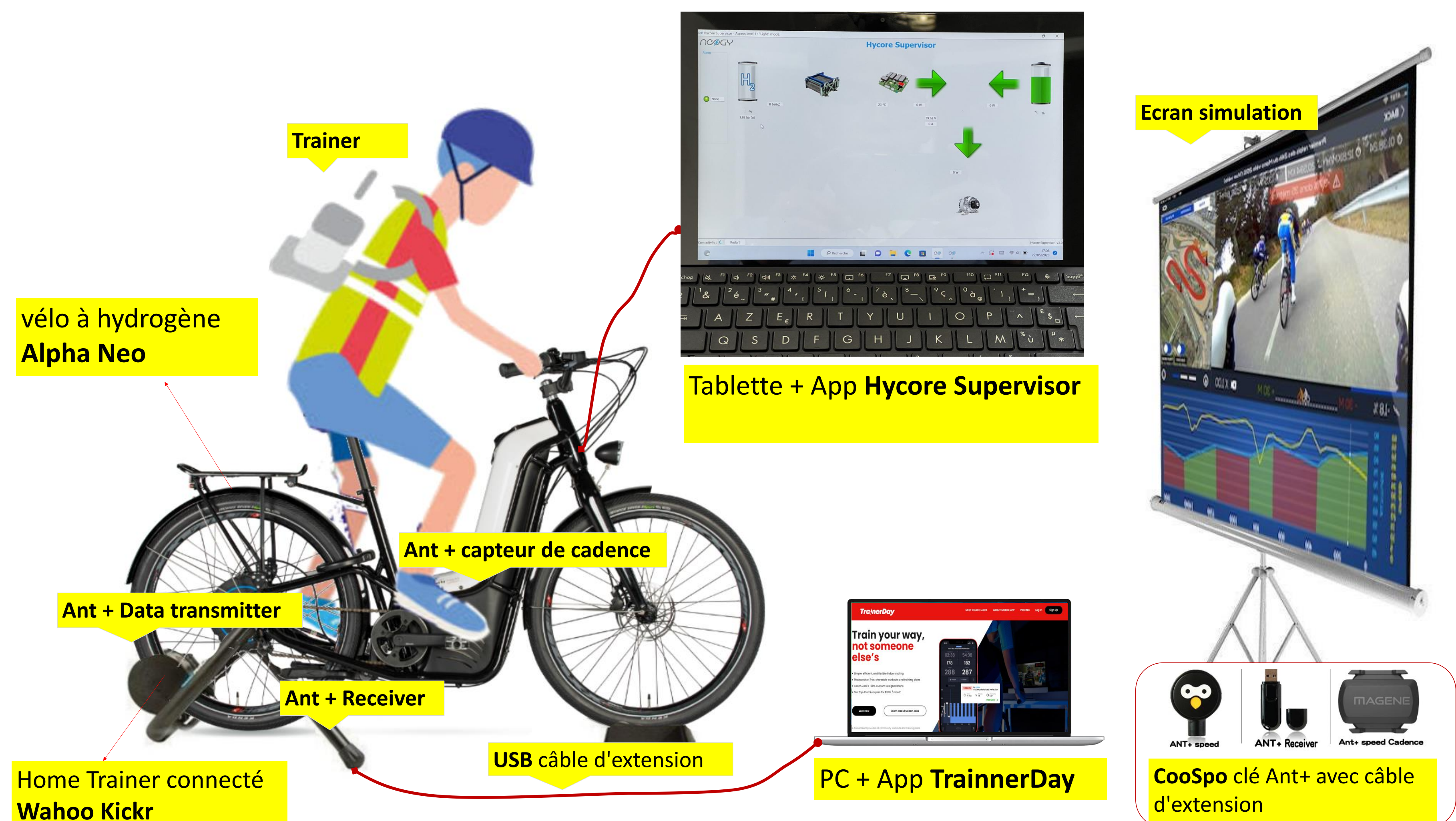
Schéma principe du banc d'essai
